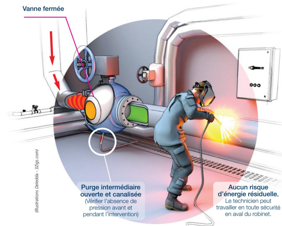
Extrait de la norme NF EN 12266-1 3.8 – Robinet double sectionnement-et-vidange Appareil de robinetterie avec deux surfaces d'étanchéité séparées, qui lorsqu'il est en position fermée, sectionne le débit depuis les deux extrémités lorsque la cavité entre les deux surfaces d'étanchéité est ventilée à travers une connexion de vidange entre le corps de la cavité et l'environnement extérieur.
