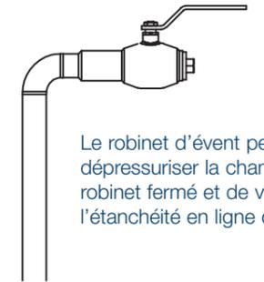
Le robinet d'évent permet de dépressuriser la chambre morte robinet fermé et de vérifier ainsi l'étanchéité en ligne du robinet.
