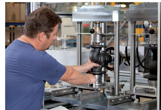
Tous les robinets sont testés en fin de fabrication selon l'EN 12266-1 sans aucune fuite acceptable ni vers l'extérieur (tests P10 et P11) ni en ligne (test P12 taux A).
