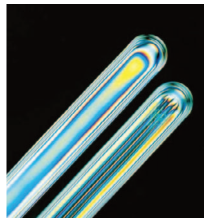
Glaces KLINGER soumises au test de la lumière polarisante
