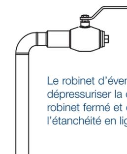
Le robinet d'évent permet de dépressuriser la chambre morte robinet fermé et de vérifier ainsi l'étanchéité en ligne du robinet.
