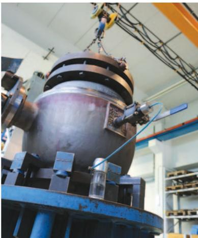
Chaque siège est testé séparément selon l'EN 12266-1 avec 6 bar à l'air (Test P12). Le robinet doit présenter un taux d'étanchéité A (zéro fuite, zéro bulle) pendant toute la durée du test.
