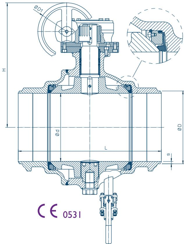
Élément d'étanchéité précontraint maintenu sur 3 côtés et protégé de l'abrasion du fluide
