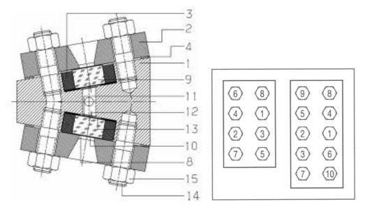
COUPLE 150 Nm à froid 120 Nm à chaud
