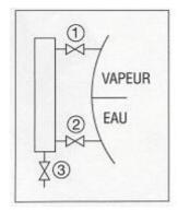
Vérifier que les robinets d'isolement 1 et 2 soient bien fermés (de même que les robinets d'isolement primaires si existants);
