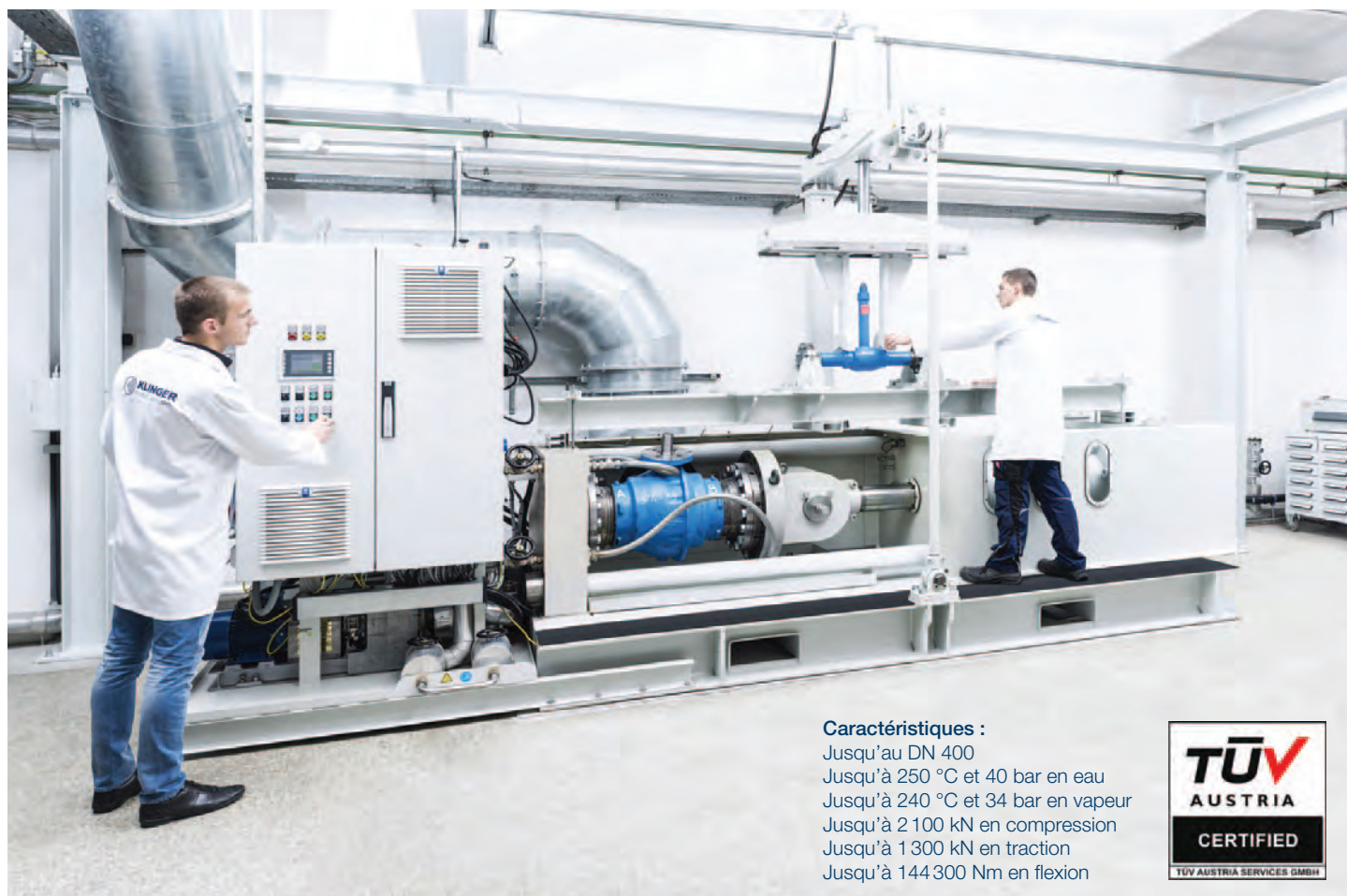
Banc d'essai de l'usine KLINGER certifié par le TÜV Autriche pour tester les robinets selon l'EN 488:2015
