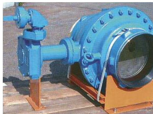
Robinet Ballostar KHSVI 150-800 avec extension de manœuvre, réducteur manuel avec indicateur de position et renvoi d'angle.
