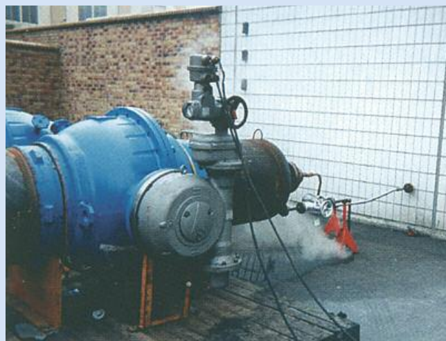
CPCU Paris : Essais / vapeur surchauffée 235 °C 20 bar
