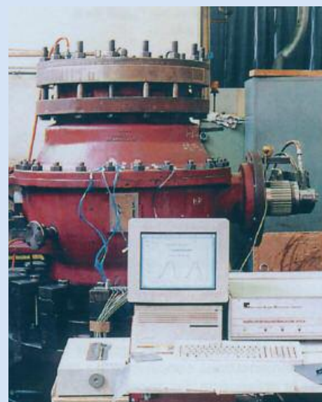
Des capteurs permettent de mesurer la déformation du corps en acier soumis à des séries successives de contraintes
