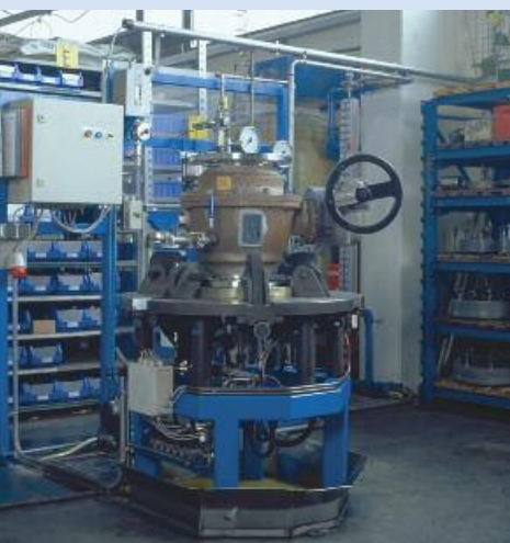
Série d'essais sur robinet Ballostar
